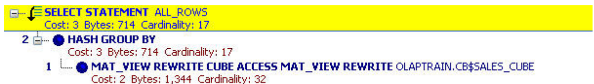
Slika 7: Plan izvršavanja korištenjem podataka iz OLAP kocke (cube query rewrite)
